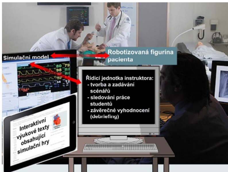
Obrázek 9 – Naším perspektivním cílem je vytvoření lékařského trenažéru využívajícího robotizovanou figurínu pacienta pro nácvik lékařského rozhodování. Simulační model přijímá vstupy z robotizované figuríny (např. simulovaná terapie), z připojeného počítače nebo z řídicí jednotky instruktora, výstupy modelu ovlivní chování figuríny, změni informace na připojeném monitoru i informace na řídicí jednotce instruktora.
