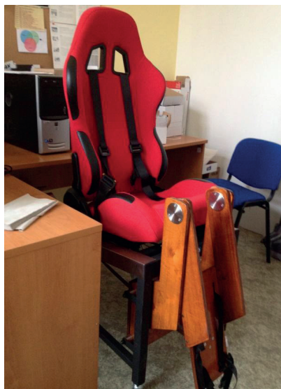
Obrázek 1 — Křeslo pro prováděný experiment se speciálním nastavitelným ramenem pro úhly v kyčelním a kolenním kloubu
