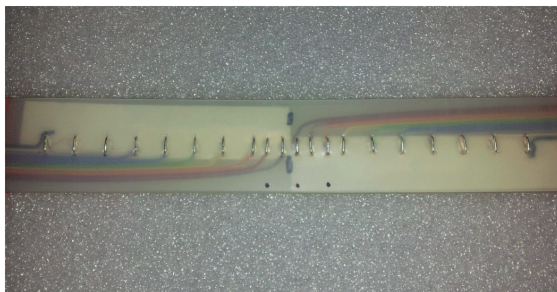
Obrázek 7 — Multikanálová elektroda pro měření povrchového EMG
