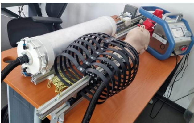
Obrázek 3 – HW torzo figuríny, žebler a mechanismu pro dýchání virtuálního pacienta
