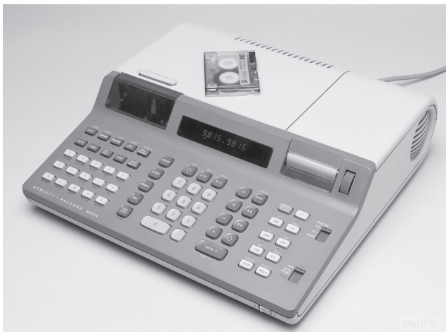
Obrázek 3 – Hewlett Packard HP 9815A programovatelný kalkulátor pro řízení Reaction Rate-Dependent analyzátoru LKB Ultralab 2086
