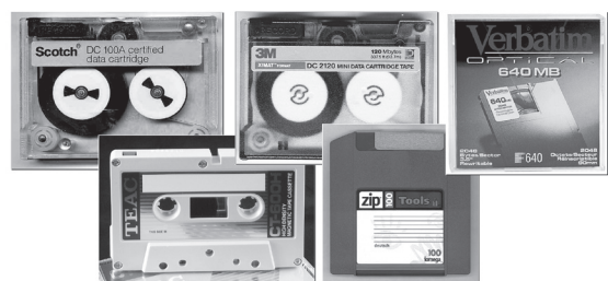
Obrázek 12 – Datová média pro archivaci dat v laboratoři gastroenterologie 1.LF UK a VFN, Scotch DC 100A, TEAC CT-600H, 3M DC 2120, lomega ZIP 100 a Verbatim 640 MOD
