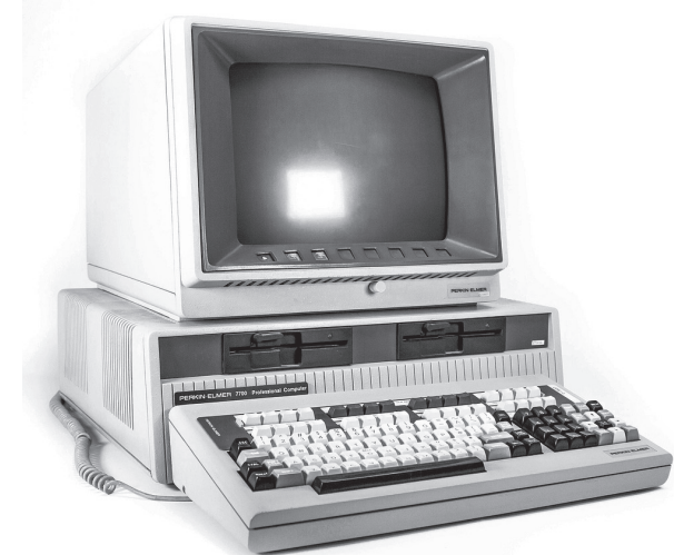
Obrázek 4 – Model 3600 Data Station programovatelný CRT terminál pro HPLC chromatograf Perkin Elmer
