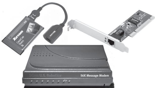
Obrázek 11 – Dial-up konektivita k internetu 56 kb/s externí modem U.S.Robotics, D-Link interní karta a PCMCIA karta Xircom
